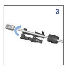
Install the cable clamp-boot.
