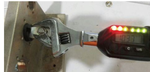
d、 听到报警声，停止扭动扳手。 Stop fastening screw when it alarms.
