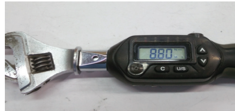
b、 根据表一，设置扭力扳手的控制上限值 Setting upper limit torque according to table.1
