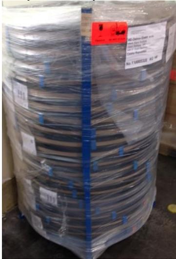
Bei Versendungen einzelner Bänder ohne Gestelle müssen diese in Karton verpackt werden / For shipment of individual contacts on reels without stands must be packaged in carton
