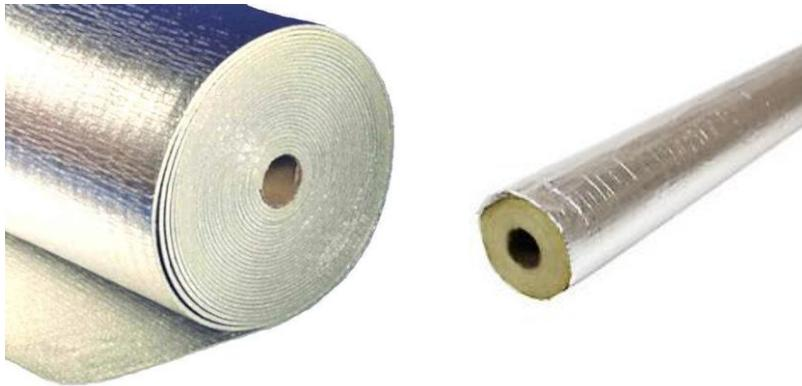
Reflexionsfolie ist eine zusätzliche Möglichkeit die Wärmedämmung von Heizungsrohren zu verbessern. Durch sie wird die langwellige Wärmestrahlung nach innen zurück reflektiert. Wird häufig auch zum Beispiel hinter Heizkörpern angebracht.
